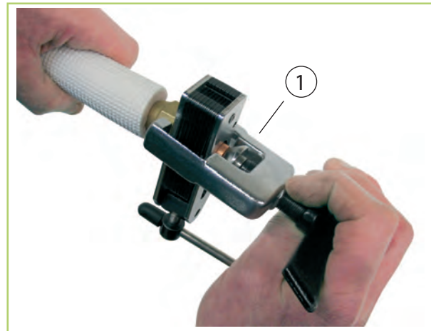
Obr. 41: Flérování vedení chladiva
